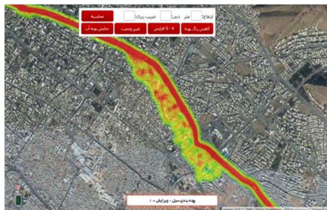
شکل ۳: پهنه‌بندی سیل با ارتفاع آب ۵ متر در رودخانه خشک شیراز توسط مدل
