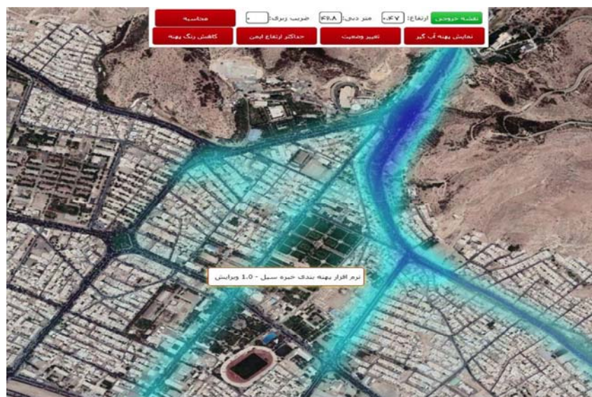
شکل ۱۵: پهنه‌بندی سیل فروردین ۱۳۹۸ در محدوده دروازه قرآن شیراز (رنگ آبی مسیر عبور سیل و رنگ فیروزه‌ای محدوده آب-گیری شده را نشان می‌دهد).
