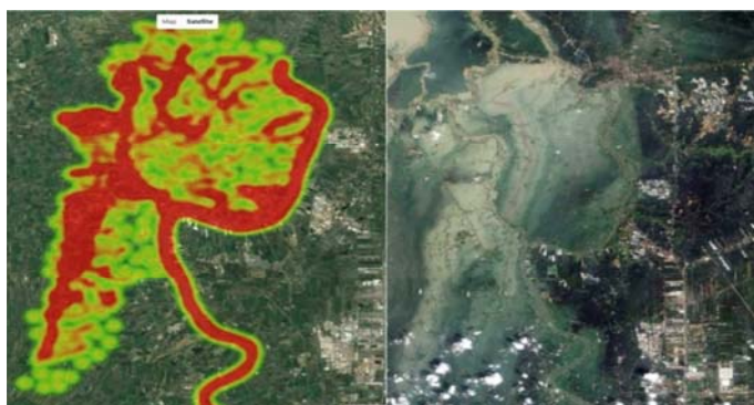
شکل ۱۳: مقایسه تصویر ماهواره‌ای سیل اکتبر ۲۰۱۱ تایلند (راست) با نقشه پهنه‌بندی سیل توسط نرم‌افزار (چپ)
