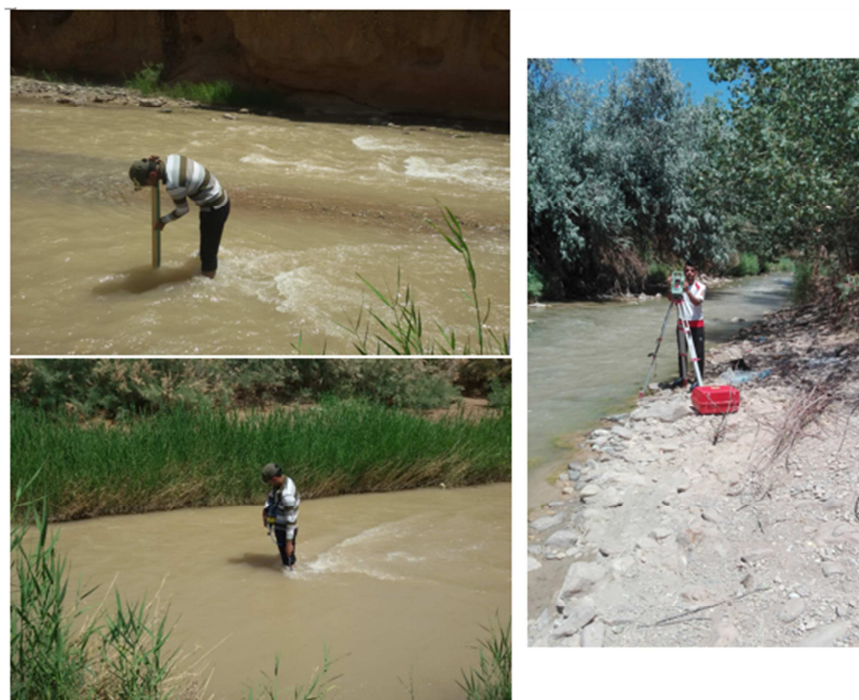
شکل ۲: عملیات میدانی نقشه‌برداری و اندازه‌گیری پارامترهای جریان در بازه مورد مطالعه
